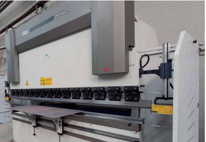
Realiza doblado profundo o semi cerrado con control digital a través de un codificador óptico. Adicionalmente, esta prensa plegadora CNC controla el sistema de posicionamiento trasero y tiene compensación automática para la deformación de la mesa de trabajo.
